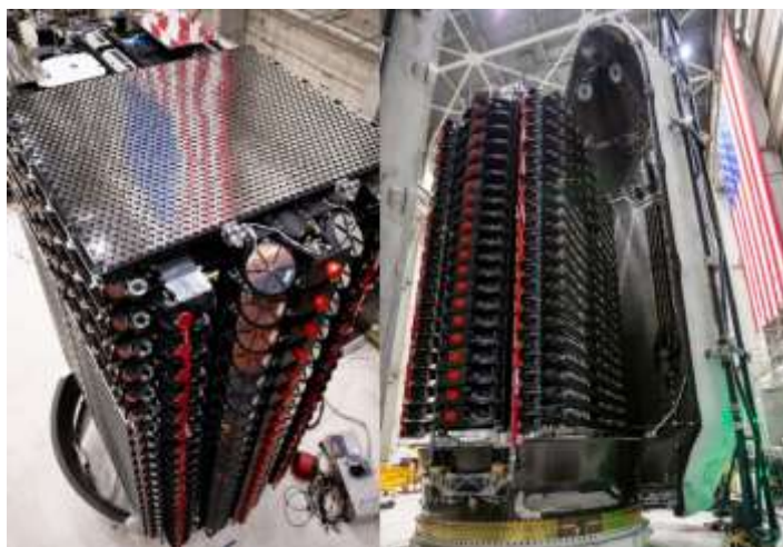
شکل ۳: پشته‌ی آماده‌ی پرتاب از ۶ ماهواره V ۲ mini استارلینک با قابلیت D ۲ C [۸]
