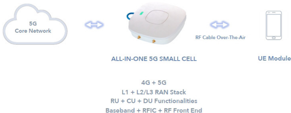
شکل ۱.۱ در زمان استفاده به عنوان یک ایستگاه پایه، سیلیکون EdgeQ به یک هسته 5G وصل می شود [۱].
