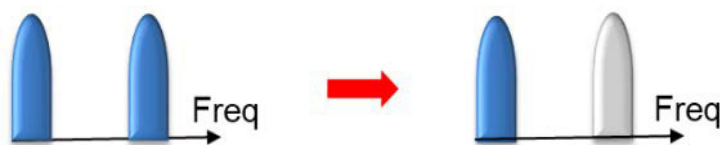
شکل ۲- توصیف صرفه‌جویی انرژی در حوزه فرکانس؛ یکی از دو حامل (و بخش رادیویی مربوطه) غیر فعال شده‌اند.
