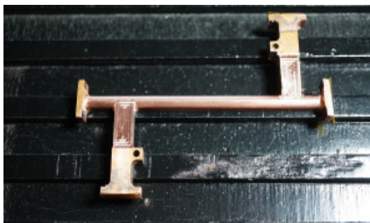
شکل ۱۸. شکل لوله تفنگ نهایی پس از ماشین‌کاری کاری نهایی CNC [۲۰]
