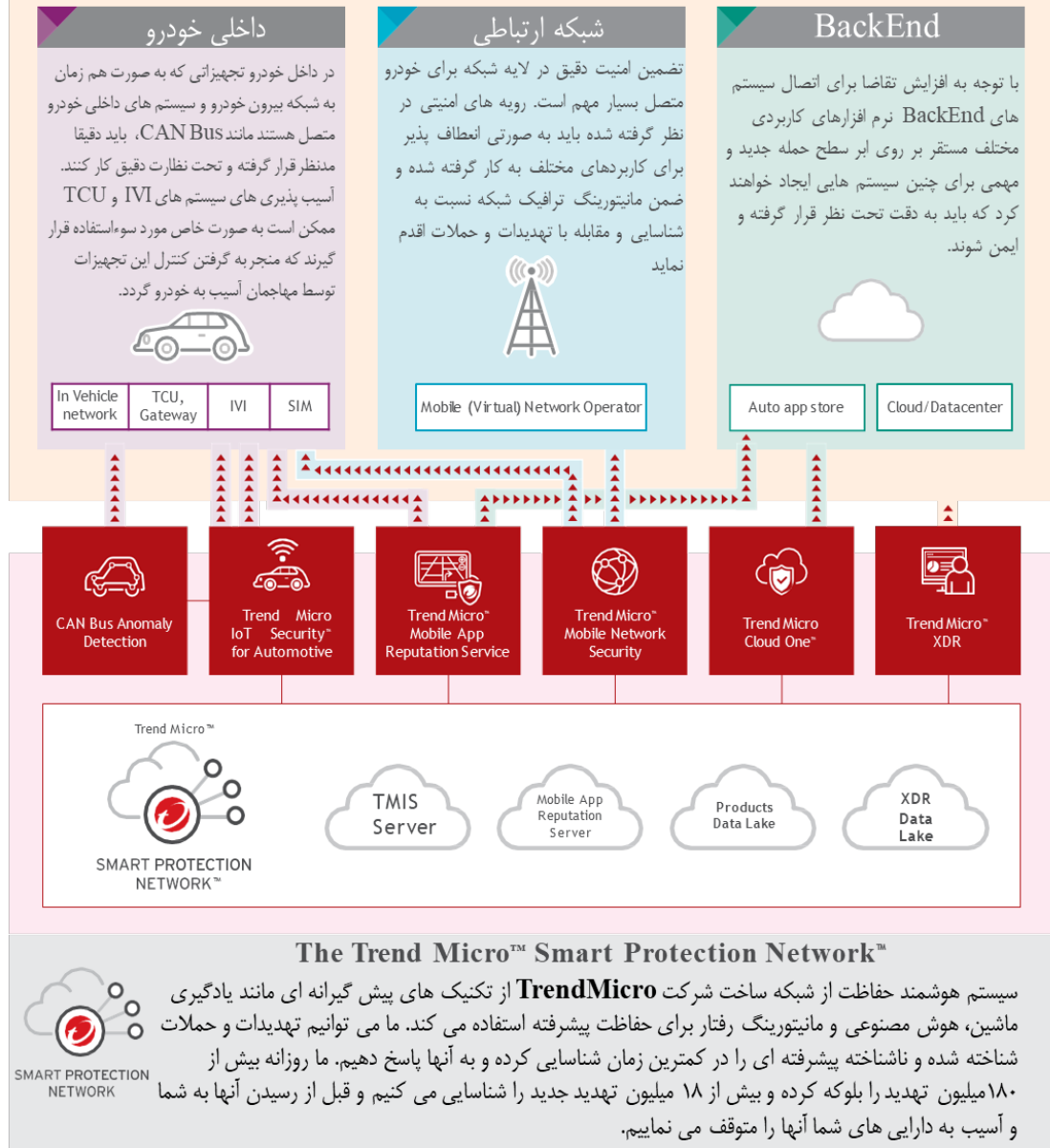
شکل ۶- راه کار TrendMicro برای تضمین امنیت در زیرساخت خودروهای متصل (Connected Car) [۵]
